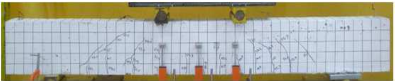
(d) BS-02 (pre-cracked 90% of ultimate load)
